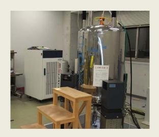
機器: 日本ブルカー社avance 500MHz NMR 特徴: 多核種観測用プローブ(BBFO) 5mm, 簡易測定機能あり, オートサンプルチェンジャーあり 対象サンプル: 有機化合物など
